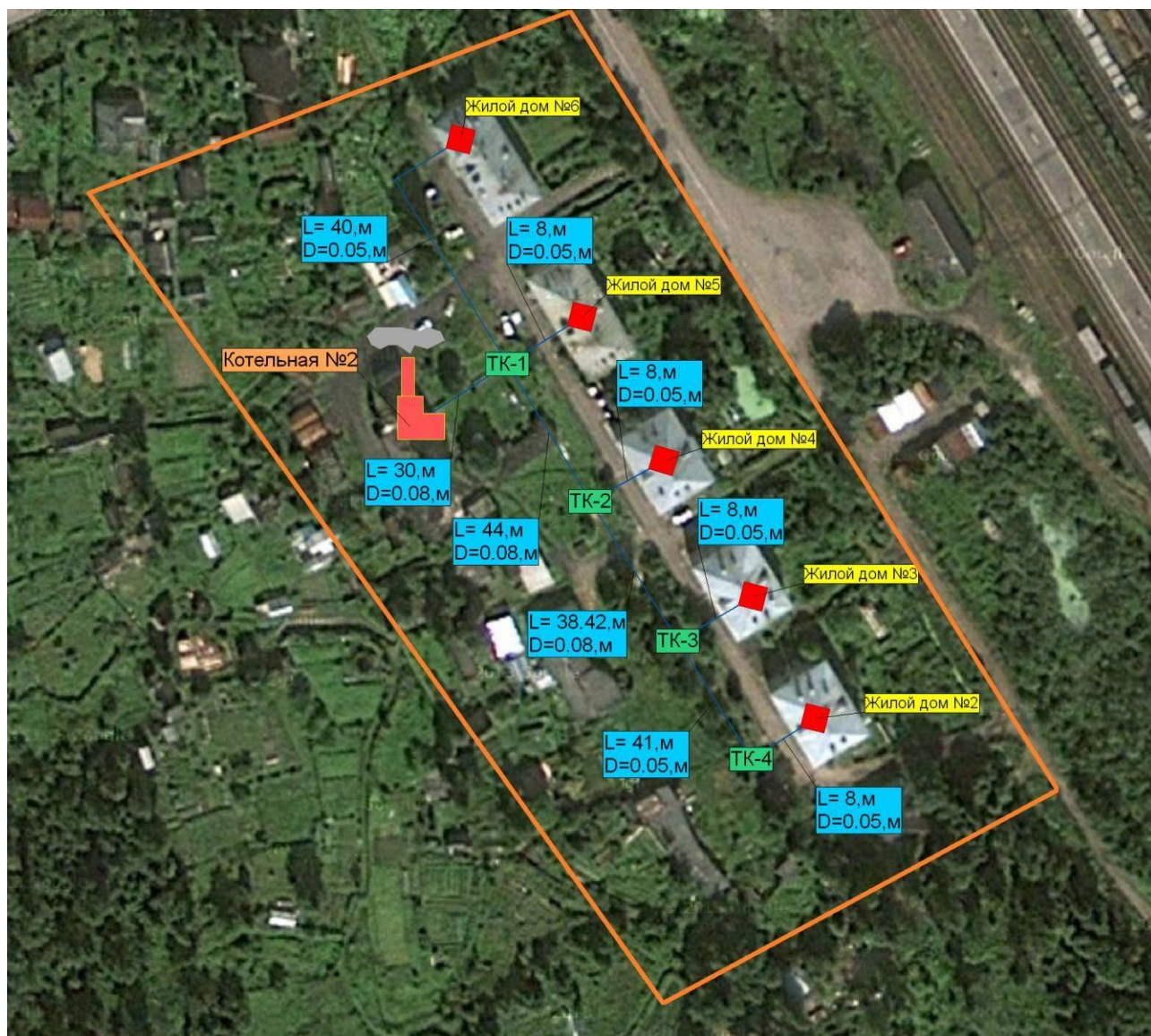
Рисунок 2.1.4.2 - Зона действия централизованного источника теплоснабжения №25 (ст. Пери)
