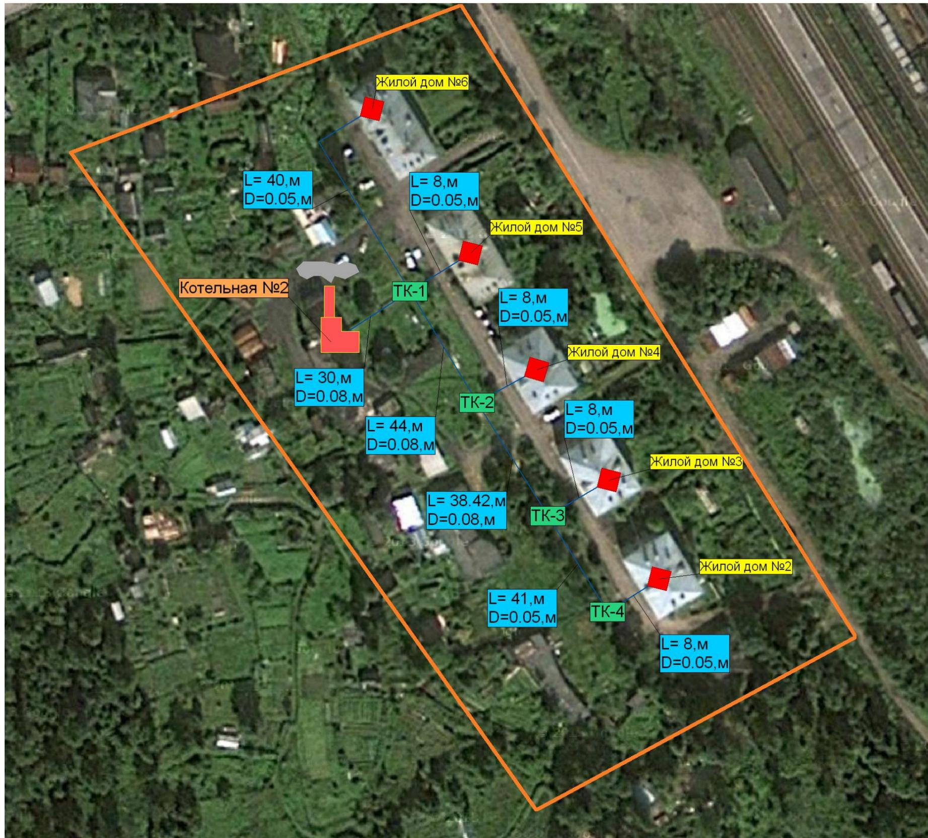
Рисунок 8 - Зона действия централизованного источника теплоснабжения котельной №25 (ст. Пери).
