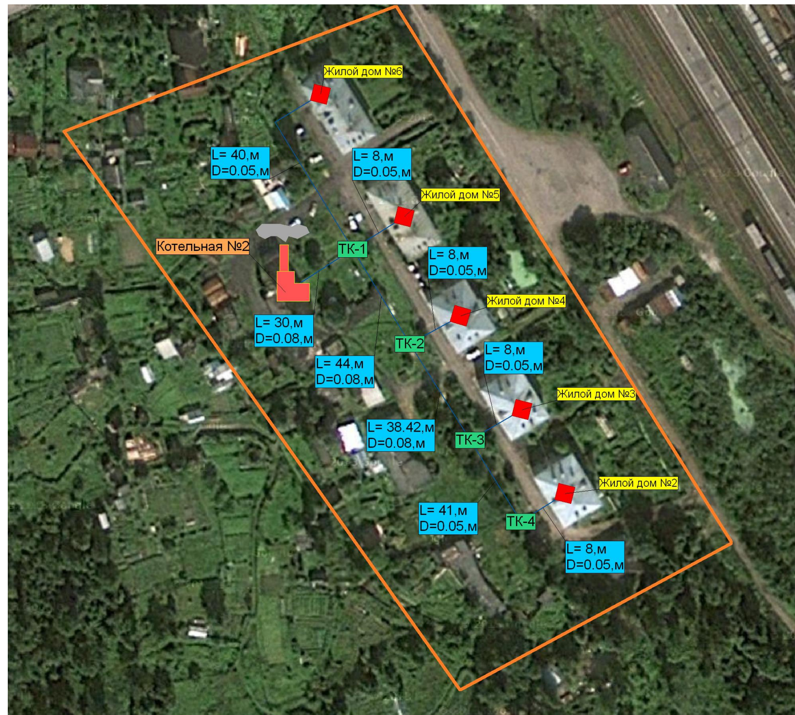
Рисунок 5 - Зона действия централизованного источника теплоснабжения №25 (ст. Пери).
